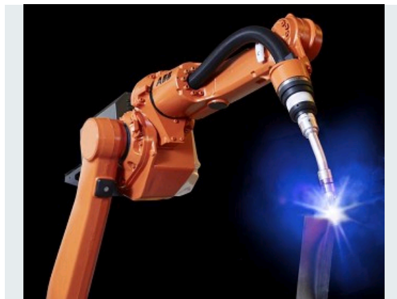
SOUDEGE ROBOTISÉ AVEC PROCESS INTÉGRÉ
