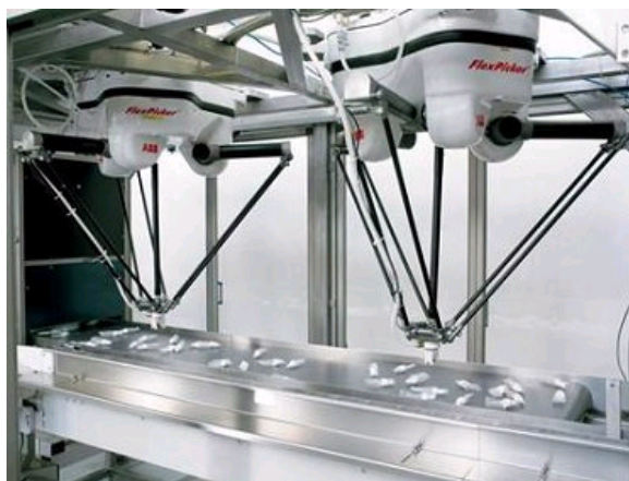
LIGNE ROBOTISÉE D'ÉTUYAGE AVEC FLEXPICKER ABB
