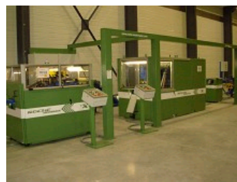
LIGNE DE METAL DEPLOYE POUR FABRICATION DE PLAQUES DE BATTERIES
