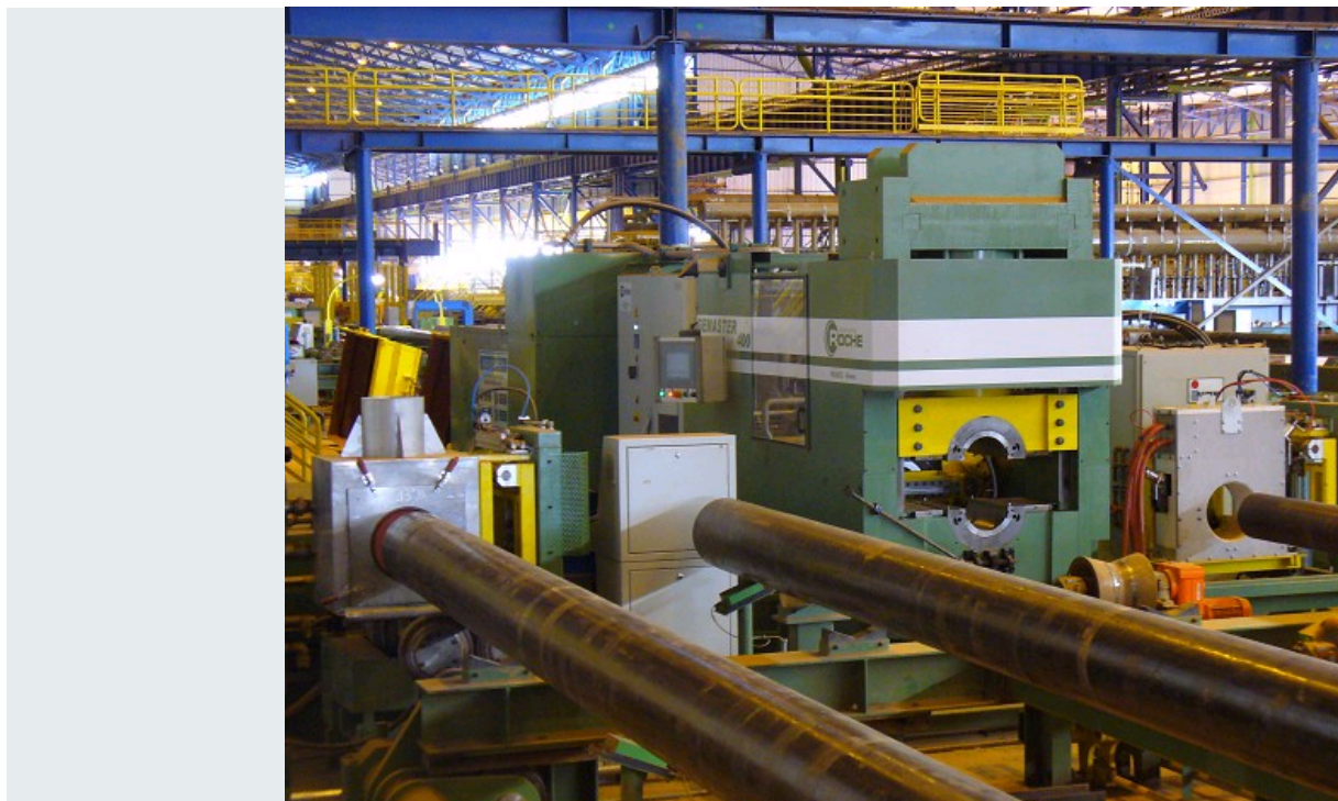
CELLULE COMPLÈTE DE CALIBRATION, CONIFICATION DE TUBES OIL&GAS
