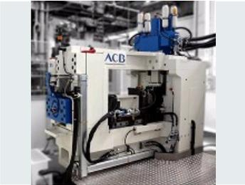
MACHINE DE SOUDAGE PAR FRICTION LINÉAIRE
