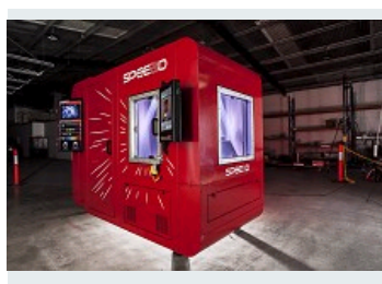
SPEE3D EST LA PREMIÈRE TECHNOLOGIE DE FABRICATION ADDITIVE REPOSANT SUR LE PROCÉDÉ COLDSPRAY.
