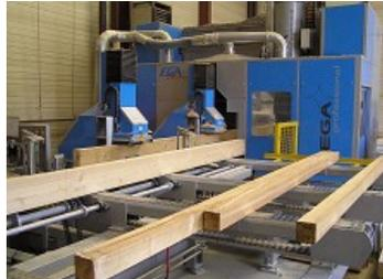
**VEGA** : CENTRE D'USINAGE 5 AXES POUR CHARPENTES ET CONSTRUCTIONS BOIS. MAGASIN AUTOMATIQUE DE 25 OUTILS
