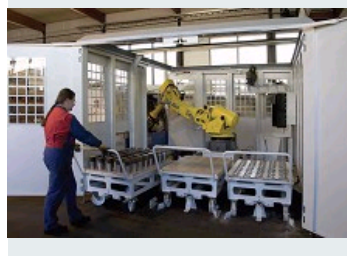
ROBOTIC - RPC TRIPPLE TROLEYS : SOLUTION DE CHARGEMENT / DÉCHARGEMENT DE TOURS AVEC 3 CHARIOTS
