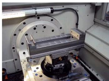
ÉTAUX COMPACTS MAKROGRIP : ADAPTÉS AUX USINAGES EN 4 ET 5 AXES
