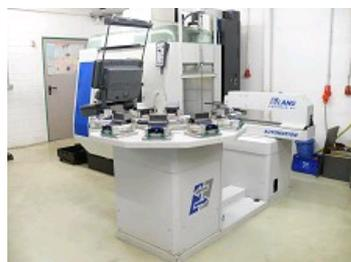
LE SYSTÈME AUTOMATION ECOCOMPACT S'INSTALLE SUR MACHINE NEUVE OU EXISTANTE
