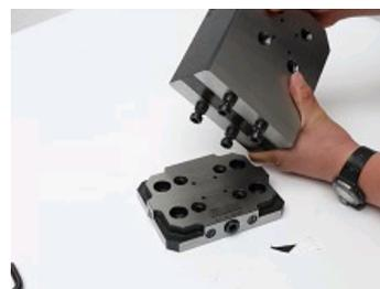
LA TECHNOLOGIE DE POSITIONNEMENT ET FIXATION RAPIDE QUICKPOINT
