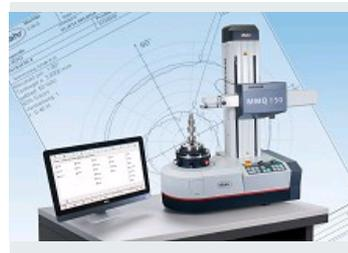
STATION AUTOMATISÉE POUR LES MESURES D'ÉCARTS DE FORME ET DE POSITION
