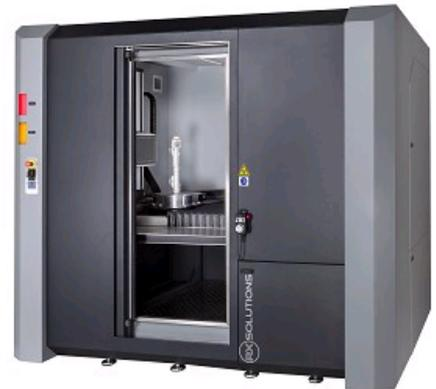
EASYTOM XL : CABINE AUTOMATISEE DE MICRO OU (NANO)TOMOGRAPHIE 3D & RADIOSCOPIE NUMERIQUE
