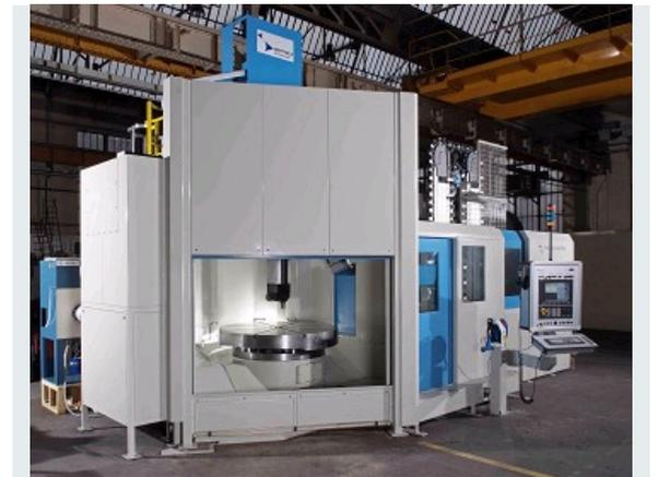
TVU 2000/160 HAUTE PRESSION 400 BAR, CAPTO C8, MAGASIN À CHAÎNE 80 POSITIONS, PALETTISÉ
