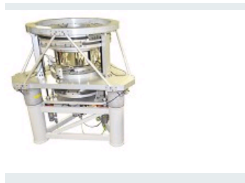
MACHINE LNE DE MESURE DE CYLINDRICITE DE REFERENCE (NANOMETRIQUE)
