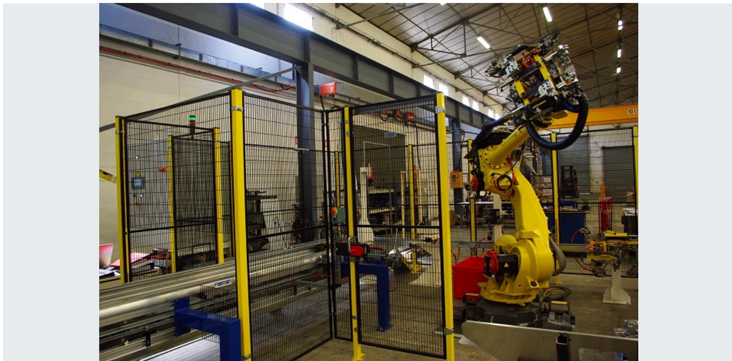
LOT ROBOTISÉ DE CHARGEMENT ET DE DÉCHARGEMENT D'UN CENTRE D'USINAGE INCLUANT LE SOUFFLAGE, LE CONTRÔLE ET LE MARQUAGE
